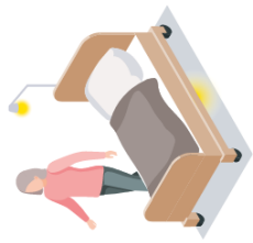
Erst das Verlassen des Bettes löst nach dem festgelegten Intervall die Benachrichtigung aus.
